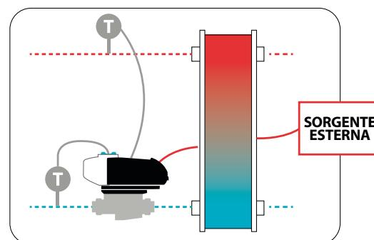
Per controllare il delta T, il flusso o la potenza in un sistema, o per mantenere **costante un terzo parametro** come la temperatura interna, la temperatura della vasca di raffreddamento del data center, e altri.
