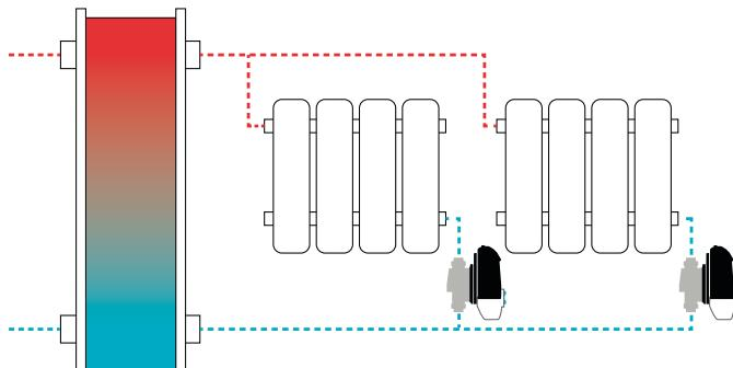
Gestione automatica del **bilanciamento idronico** in edifici nuovi ed esistenti, operando sia con funzionalità ePICV che eDPCV.
